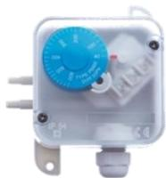
Il informe le coffret de relayage d'un débit d'air suffisant pour assurer la fonction de désenfumage. Le pressostat différentiel est équipé de contacts auxiliaires NO et NC sur 2 plages de pression : **30 à 500 Pa** et **100 à 1500 Pa** (pour les plages supérieures, nous consulter).
