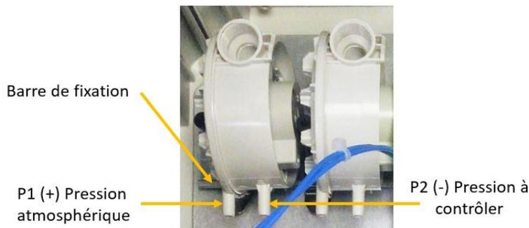
Le tuyau de l'entrée P1 (pression atmosphérique) doit ressortir hors du coffret.
