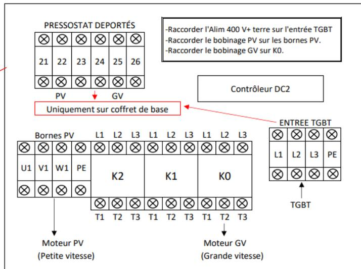
Uniquement sur coffret sans option interrupteur de proximité (IP) ou pressostat (DP)
