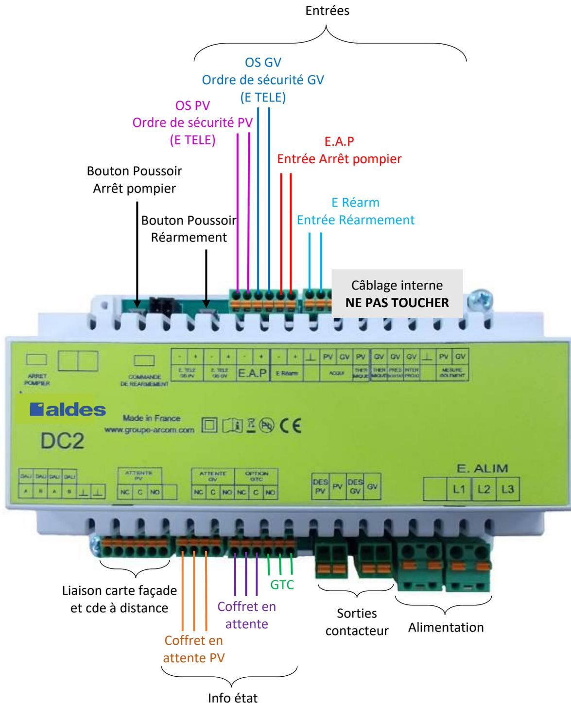
Alimentation non fournie ! Conformément à la NF S 61-937-9, il est interdit d'utiliser une sortie tension TBT ou TBTS du coffret de relayage pour alimenter les commandes de sécurité, arrêt pompier et réarmement.
