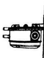
Fig. 3 : Position de montage conseillée : verticale (étalonnage en usine)
